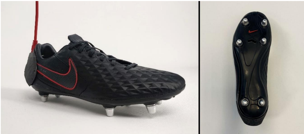
Figure 25 - A gauche, deuxième version de la chaussure (2021) équipée de 6 CI permettant de mesurer les forces verticales. Le câble rouge relie la chaussure au boîtier d'acquisition. A droite, vue de dessous, l'emplacement des 6 CI.
