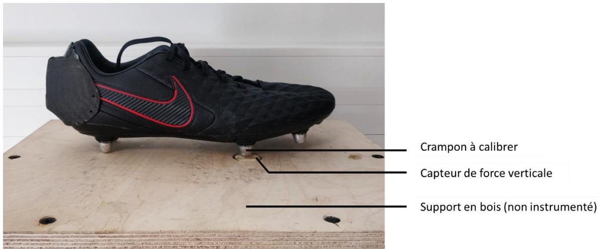
Figure 30 - Illustration de la méthode de calibration utilisée lors de cette étude (ici pour le crampon situé sous le 5ème métatarse)
